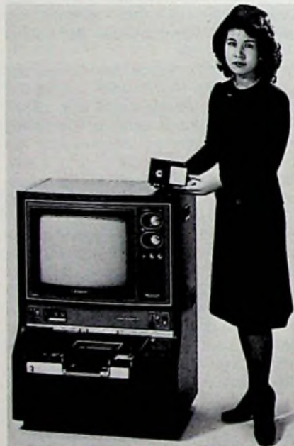
Oben: Eine bemerkenswerte Entwicklung, die in den nächsten Jahren sicherlich Bedeutung für den Markt bekommen wird, ist die sogenannte Fernsehzeitung. Die britische Firma G. E. C. führte das „Teletext“ genannte System (früher „Ceefax“ – Kunstwort für „see facts“) auf der Funkausstellung vor. Bei diesem System, auf das wir noch ausführlich zurückkommen werden, kann der Fernsehteilnehmer zusätzlich zu den Fernsehprogrammen eine Vielzahl von Nachrichtenseiten durch Knopfdruck abrufen. Auf Wunsch werden aktuelle Meldungen auch automatisch in das Programm eingeblendet.
