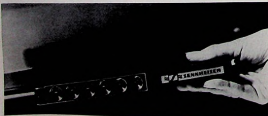
Unten: Einen Nachrüstsender für die drahtlose Tonübertragung vom Fernsehempfänger zum Kopfhörer hat Sennheiser entwickelt. Der Infrarot-Sender hat die extrem geringe Bauhöhe von 17 mm, so daß er unter jedes handelsübliche Fernsehgerät geschoben werden kann. Preisvorstellung: etwa 140 DM.
